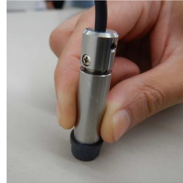
プローブの樹脂製リングの上部を写真のように持ち、測定対象物表面に垂直に、素早く、静かに先端の磁極を押し当てます。
